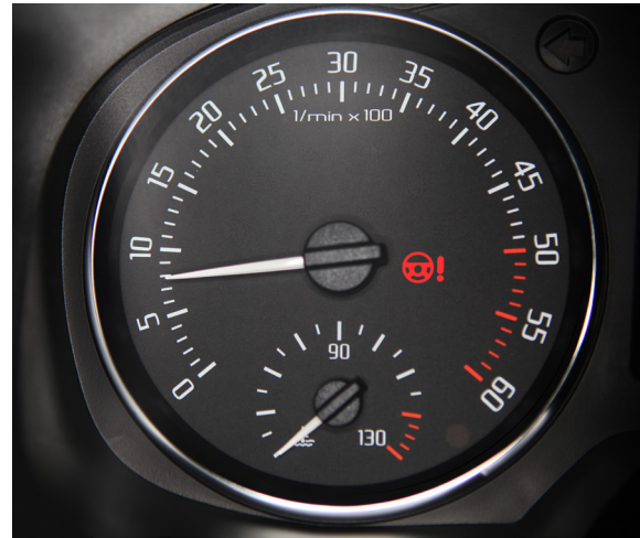
Fig. 1: Piloto de control del sistema de dirección
