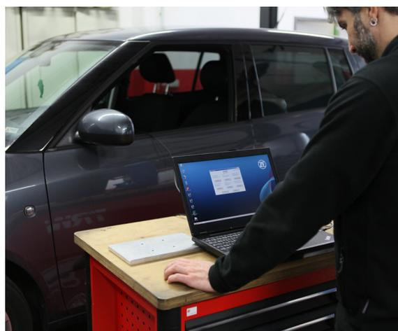
Fig. 2: Codifica della pompa del servosterzo
