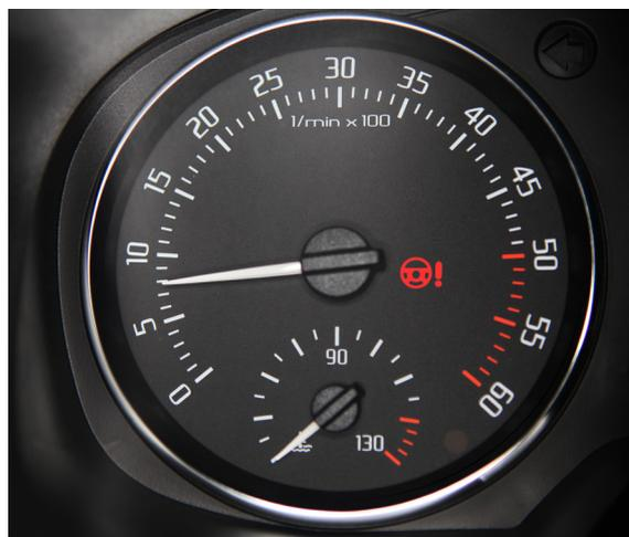
Рис. 1: Световой индикатор системы рулевого управления
