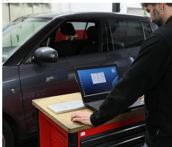
Рис. 2: Кодирование насоса усилителя рулевого управления
