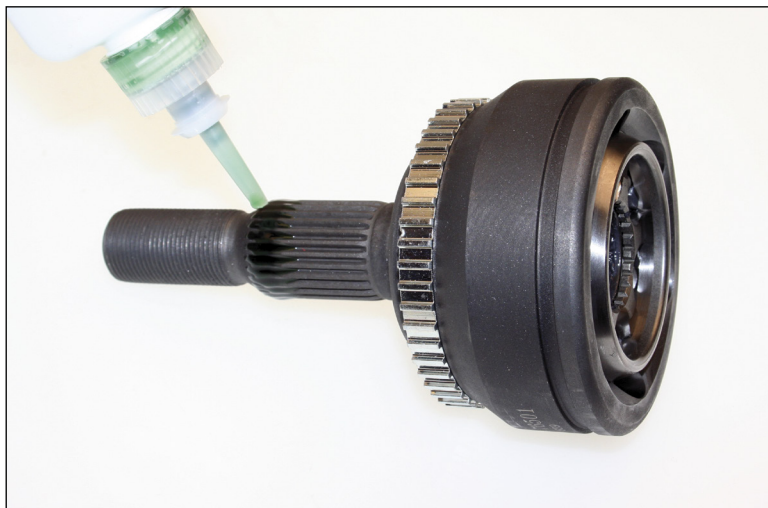
Slika 1: Točka primjene ljepila na profilu pogonske osovine
