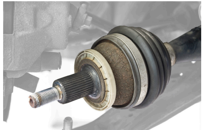
Εικόνα 1: Οι στεγανοποιητικοί δακτύλιοι μπορούν να διαφέρουν στο σχεδιασμό και στο χρώμα!
