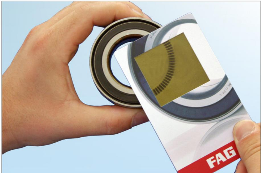
Bild 1: Detektorkarte zur Erkennung des Impulsgebers
