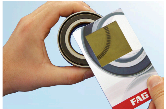
Obrázek 1: Detekční karta pro identifikaci magnetického kroužku
