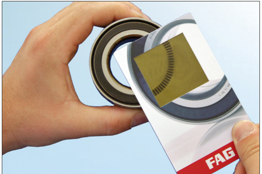
Figura 1: scheda di rilevamento per individuare il trasduttore a impulsi
