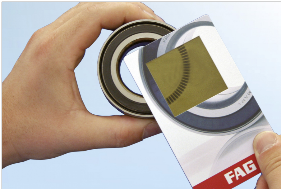
Obrázok 1: Detekčná karta pre identifikáciu magnetického krúžku
