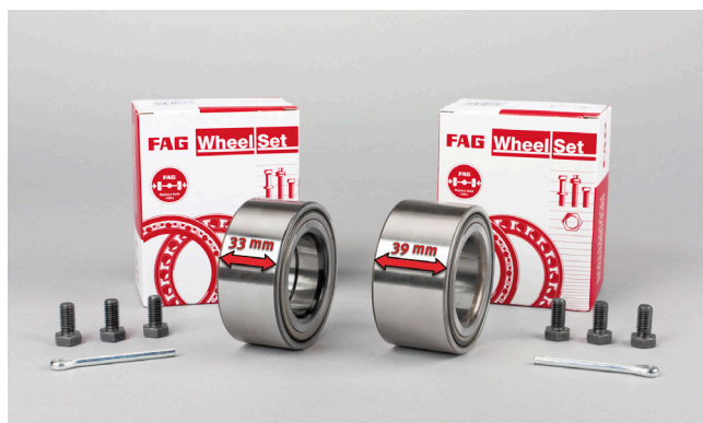
Εικόνα 1: Κωδικός ανταλλακτικού: 713 6702 20 (αριστερά) έχει ένα πλάτος 33mm Κωδικός ανταλλακτικού: 713 6702 30 (δεξιά) έχει ένα πλάτος 39mm
