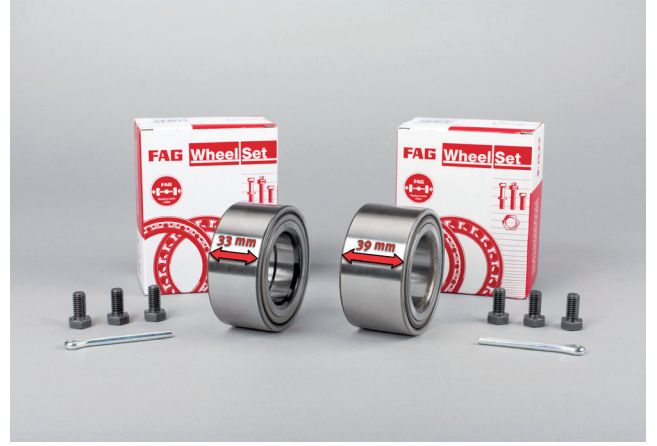
Şekil 1: 713 6702 20 referanslı rulman (sol) 33 mm genişliğindedir; 713 6702 30 referanslı rulman (sağ) 39 mm genişliğindedir;
