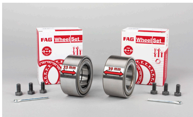
Зображення 1: Ширина підшипника з артикульним номером 713 6702 20 (зліва) становить 33 мм; ширина підшипника з артикульним номером 713 6702 30 (справа) становить 39 мм
