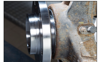
Εικόνα 3: Ο ασφαλιστικός δακτύλιος πρέπει να βρίσκεται στο ίδιο επίπεδο με το άκρο.
