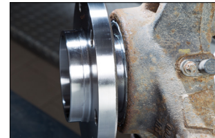
Bild 3: Låsringen måste befinna sig i samma plan som styrspindeln
