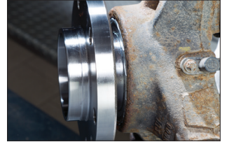
Şekil 3: Kilitleme halkası aks başı ile aynı hizada olmalıdır.
