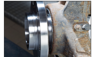
Зображення 3: Стопорне кільце повинно зайти у своє посадочне місце і бути розташованим врівень з поворотним кулаком
