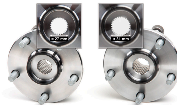
Obrázek 2: Průměr uchycení poloos je rozdílný
