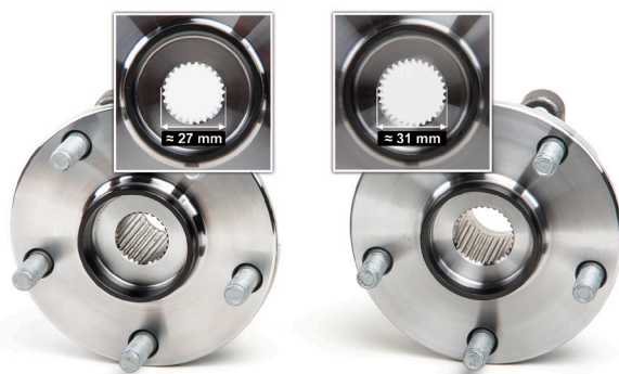
2. ábra: A féltengely csatlakozásának átmérője eltérő
