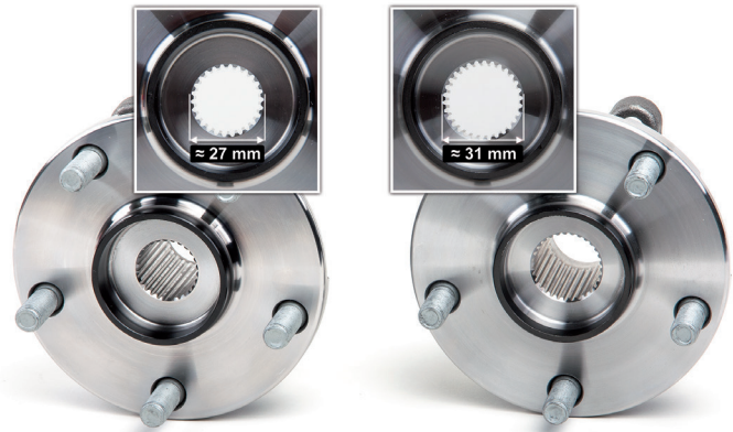
図 2 : CV ジョイントスプラインの直径の違い
