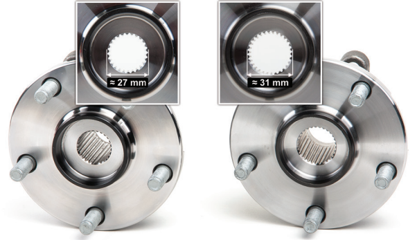
Resim 2: Aks mafsalı frezesi çapı farklıdır
