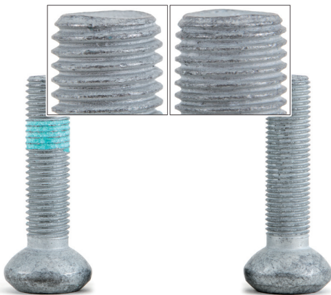
Fig. 1: Tornillo izquierdo: M12x1,5 Tornillo derecho: M12x1,25
