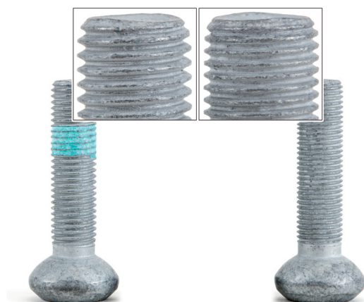
Figura 1: Vite sinistra: M12x1,5 Vite destra: M12x1,25
