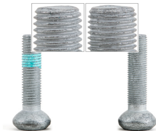
Foto 1: Śruba po lewej: M12x1,5 Śruba po prawej: M12x1,25
