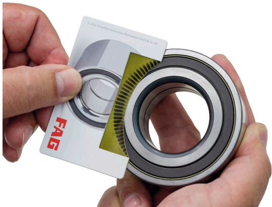
Фигура 1: Енкодер картата може да се използва за определяне на монтажната страна на многополюсен четец. С пасивни четци, това не работи.
