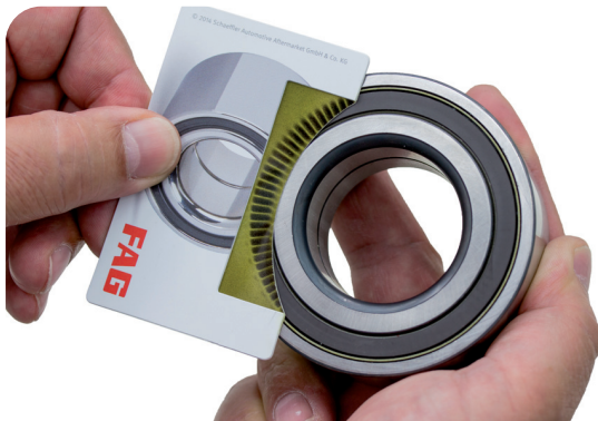
Fig. 1: El lado de montaje de un codificador multipolar se puede determinar con la tarjeta codificadora. Esto no funciona con un codificador pasivo
