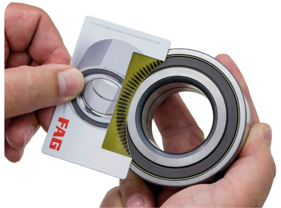
איור 1: כרטיס בדיקת המקודד ניתן לשימוש גם בכדי לזהות את כיוון ההתקנה במקרה של חיישן בעל התחלות מרובות. בחיישן פאסיבי לעומתו זה לא יצליח לזהות.
