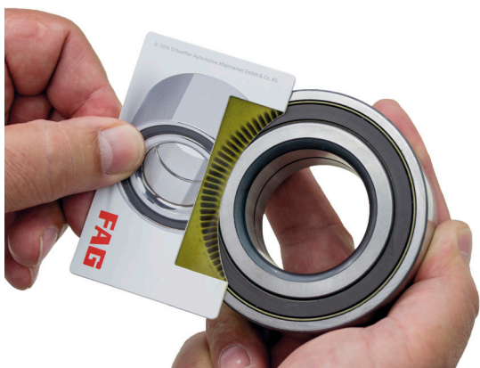
Рисунок 1: Диагностическая карточка может использоваться для определения стороны установки подшипника. С пассивными кольцами, такая проверка не действует
