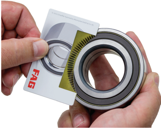
Resim 1: Çok kutuplu bir kodlayıcının kurulum tarafını belirlemek için kodlayıcı kart kullanılabilir. Pasif kodlayıcılarla, bu işe yaramaz.
