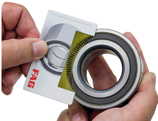
Зображення 1: За допомогою картки-декодера можна визначити яким боком слід встановлювати багатополісний декодери. Для пасивних сенсорних кільць така перевірка не діє
