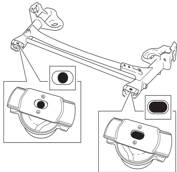
Figura 1: Orientación correcta del cuerpo del eje en el eje trasero
