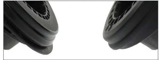
Εικόνα 1: Βάση γονάτου ανάρτησης με προστασία anti-splash (αριστερά) και χωρίς (δεξιά)
