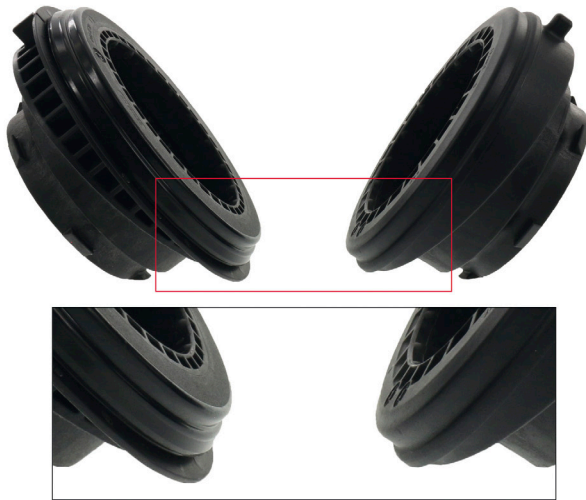
תמונה 1: תודבת בולם עליונה בעלת מגן התזת רפש (שמאל) וללא מגן התזת רפש (ימין)
