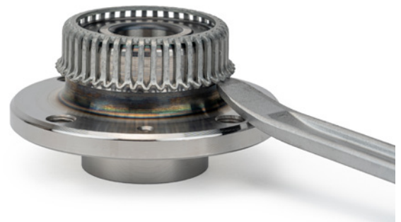
Bild 2: Die Demontage des Sensorrings erfolgt beispielsweise mit einem Montierhebel und muss durchgeführt werden, wenn das Radlager bei Fahrzeugen ohne ABS eingebaut wird.
