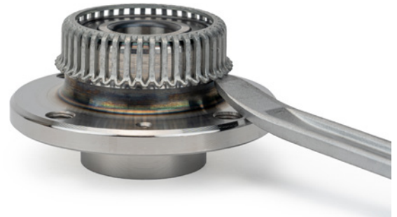
Fig. 2: El desmontaje del anillo sensor puede realizarse, por ejemplo, con una palanca de montaje, y es obligatorio si el rodamiento de rueda va a instalarse en un vehículo sin ABS.
