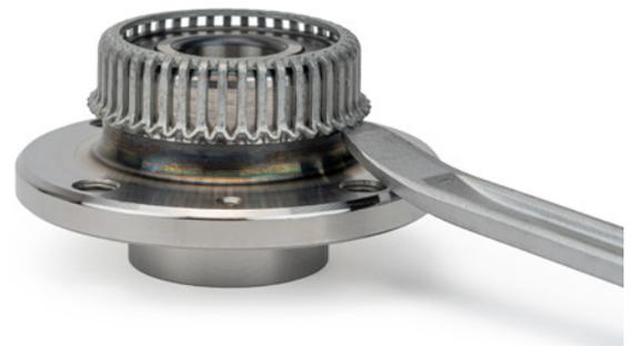
Image 2 : Le démontage de la bague s'effectue par exemple à l'aide d'un levier démonte pneus et doit être réalisé lorsque le roulement de roue est monté sur un véhicule sans ABS.
