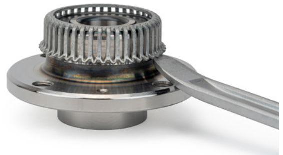
Afbeelding 2: De sensorring wordt bijvoorbeeld gedemonteerd met een montagehefboom en dit moet gebeuren wanneer het wiellager wordt ingebouwd in voertuigen zonder ABS.
