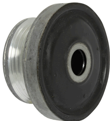
Obrázek 1: Zadní strana řemenice s alternátorovou volnoběžkou pro ztlumení vibrací
