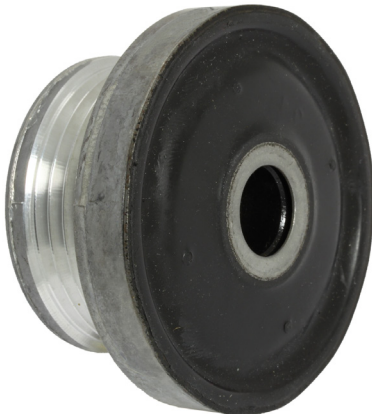
Kuva 1: Tärinää vaimentavalla vapaapyörällä varustetun laturin hihnapyörän takaosa
