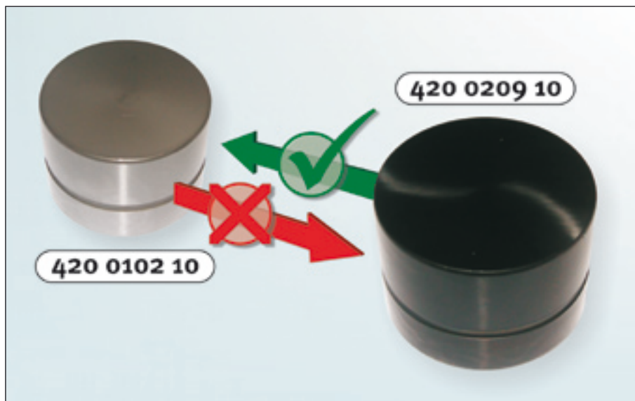
Fig. 1: 420 0102 10 is niet uitwisselbaar met 420 0209 10
