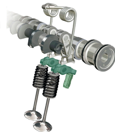
Billede 1: Oversigt over BMW Valvetronic
