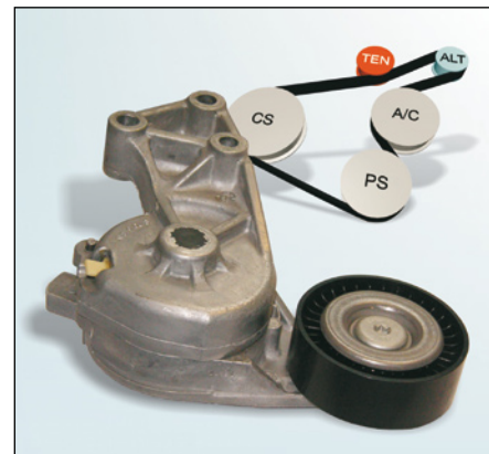
Image 2 : Bras tendeur 534 0132 30 monté dans le moteur 1,9 TDI avec cheminement de la courroie
