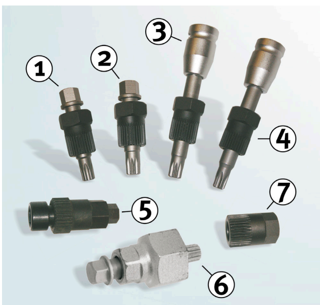
Снимка 5: Специални инструменти за монтаж и демонтаж на различни ролки със свободен ход
