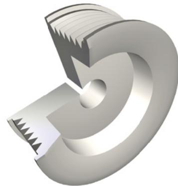
Fig. 2: Polea rígida
