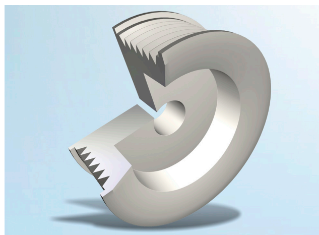
Figura 2: Rolă rigidă pentru cureaua de transmisie
