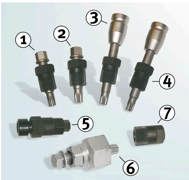
Figura 5: Unele speciale necesare pentru demontarea și montarea diferitelor role pentru transmisie cu roată liberă
