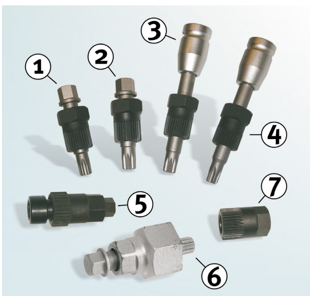
Bild 5: Specialverktyg för demontering och montering av olika frinavremskivor
