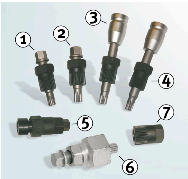
Зображення 5: Необхідний спеціальний інструмент для демонтажу та монтажу різних шківів генераторів з обгінними муфтами
