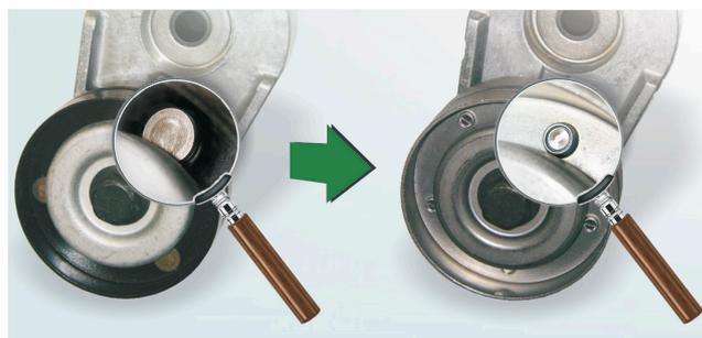
Рисунок 1: Увеличенный вид различий роликов предыдущей конструкции (слева) и новой конструкции (справа)
