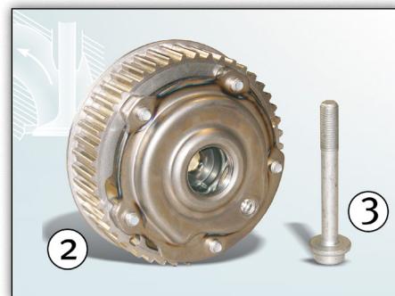
Slika 2: Ispušni fazni varijator bregaste osovine Kat. Br. 427 1005 10 i središnji vijak 41301*
