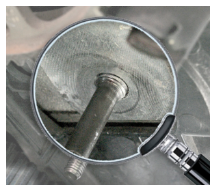
Billede 1: Støtteboltens gevind er ikke skruet korrekt
