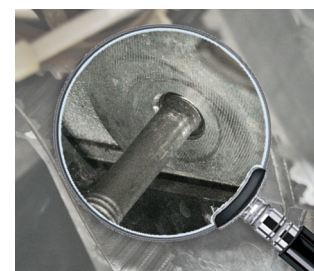
Billede 2: Støtteboltens gevind er skruet korrekt
