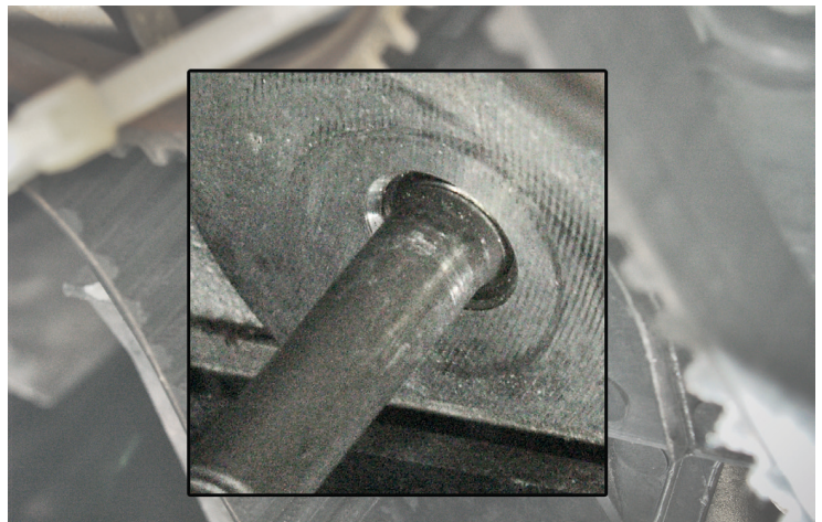
Fig. 2: El espárrago está roscado correctamente
