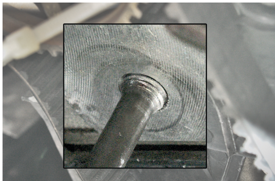
Fig. 1: El espárrago no está roscado correctamente
